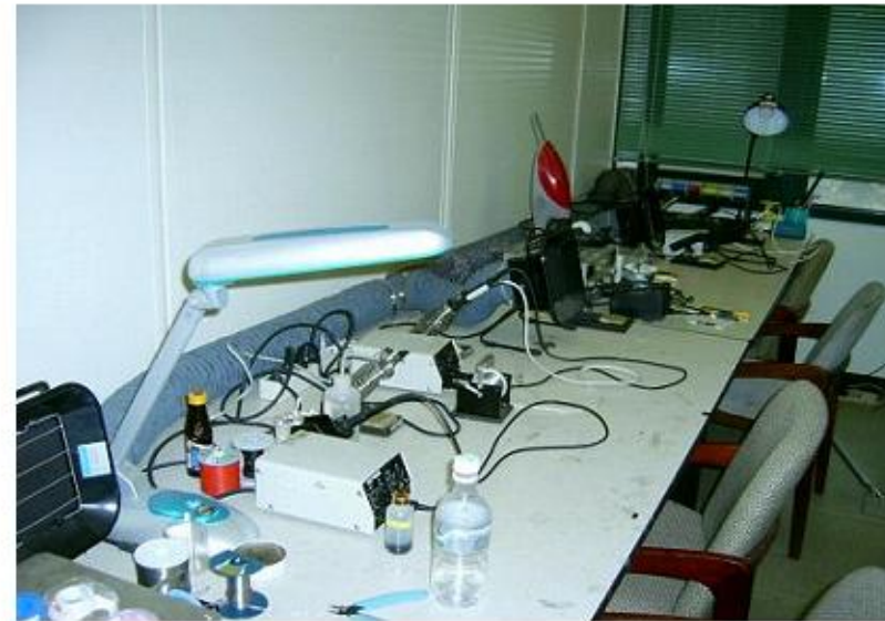
● 국소배기장치가 설치된 납땜 전용 룸
