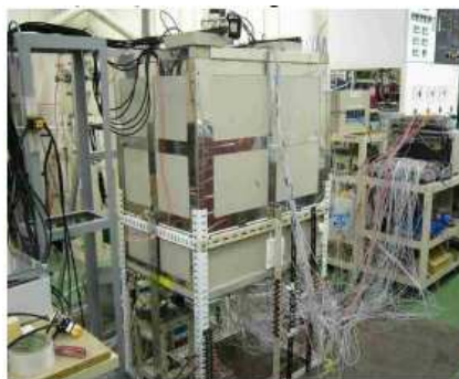
그림. 3kW급 자열식 SOFC 모듈
