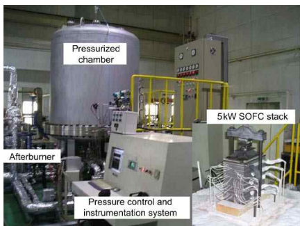
[그림 3] 연료전지-가스터빈 하이브리드 시스템 실제형상
