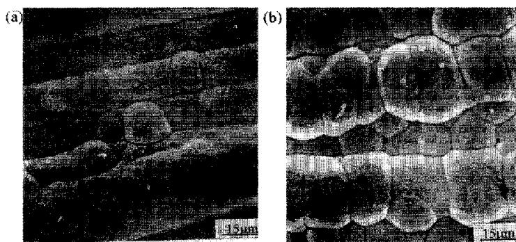
**3.3. 증착 속도 :** SEM 사진을 이용하여 미세기공과 거대기공에서의 SiC코팅두께를 측정하여, 증착 시간으로 나누어, 증착속도를 측정하였다. 거대 기공내 증착속도가 미세 기공내 증착 속도보다 높았다.
