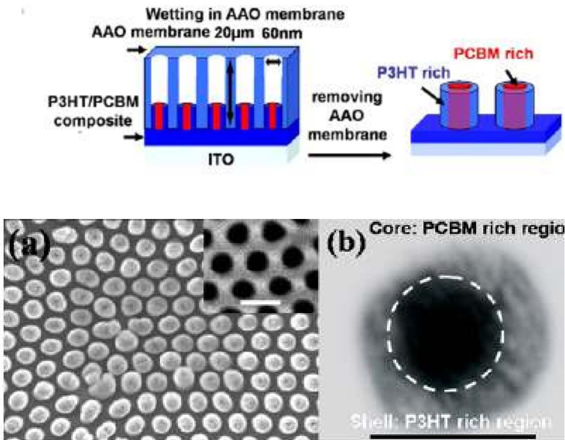
65nm 다공성 AAO 구조를 이용하여 효율(Power conversion efficiency): 2.0 % OSC 제작.
