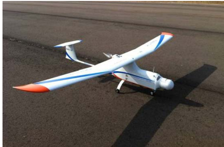
그림 7. AB 기반 수소파워팩을 사용한 무인비행기.
