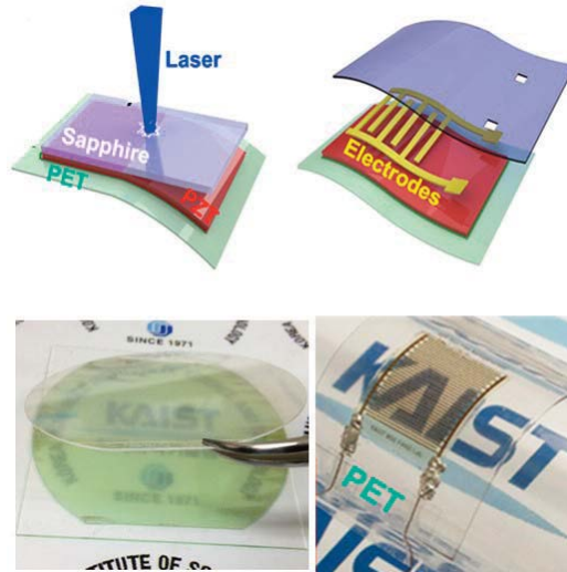
그림 2. (a) PZT 압전 에너지 하베스팅 소자의 Laser Lift Off공정. (b) LLO공정으로 떼어낸 사파이어 기판. (c)완성형 소자
