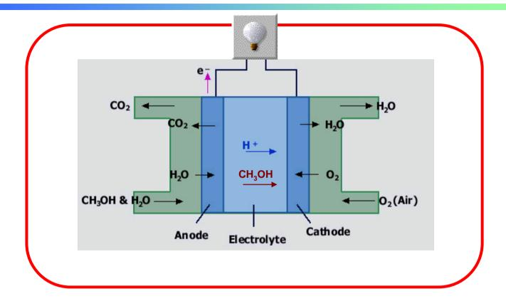
Anode:  $CH_3OH + H_2O => CO_2 + 6H^+ + 6e^-$  Cathode:  $3/2O_2 + 6H^+ + 6e^- => 3H_2O$
